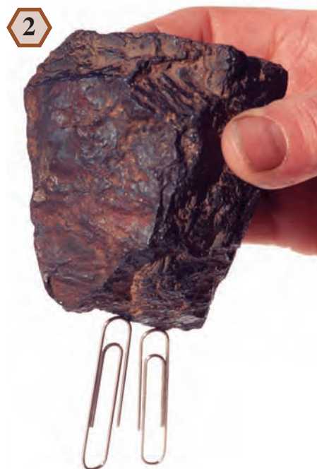
Pierre d'aimant (minerai d'oxyde de fer appelé «magnétite») qui attire deux trombones en fer, en raison de l'attraction magnétique.
